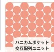
従来のピアノ線の1.3倍の強度を誇る強靱な線材を採用。交互にコイルを配置し、しっかりとした安定感のある寝心地に。
